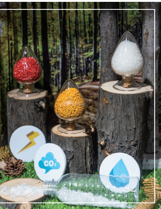
環保再生原料製成母粒或色母粒，再抽成絲，製成紗
