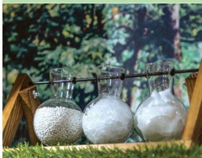
環保再生原料製成母粒或色母粒，再抽成絲，製成紗
